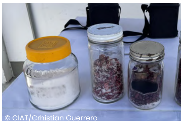
Figura 14. Verificación de la humedad del frijol con la prueba de la sal.
