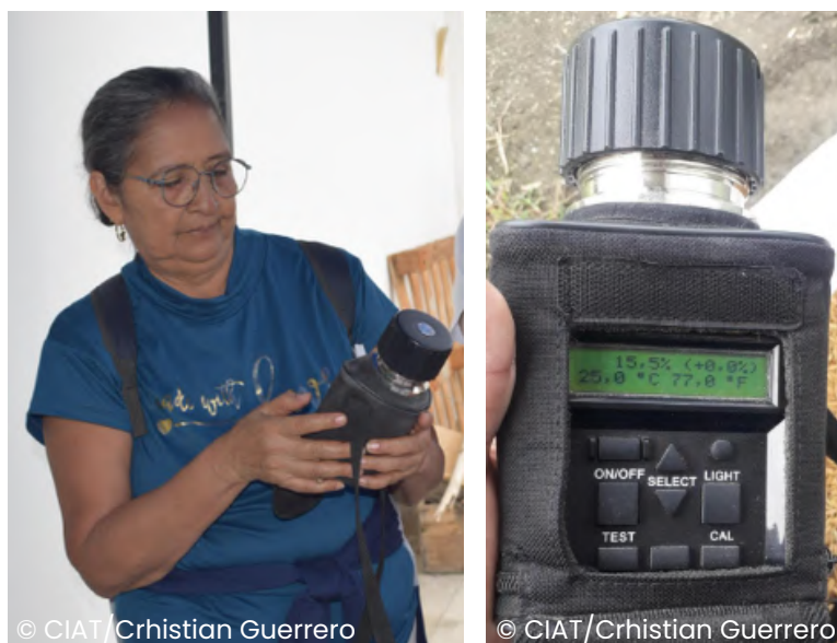
Figura 13. Verificación de la humedad del frijol usando el medidor de humedad.
