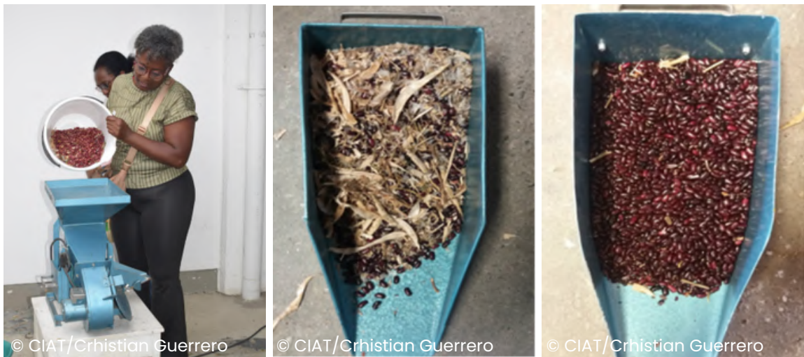
Figura 17. Limpieza del frijol con venteadora mecánica, residuos y granos limpios.
